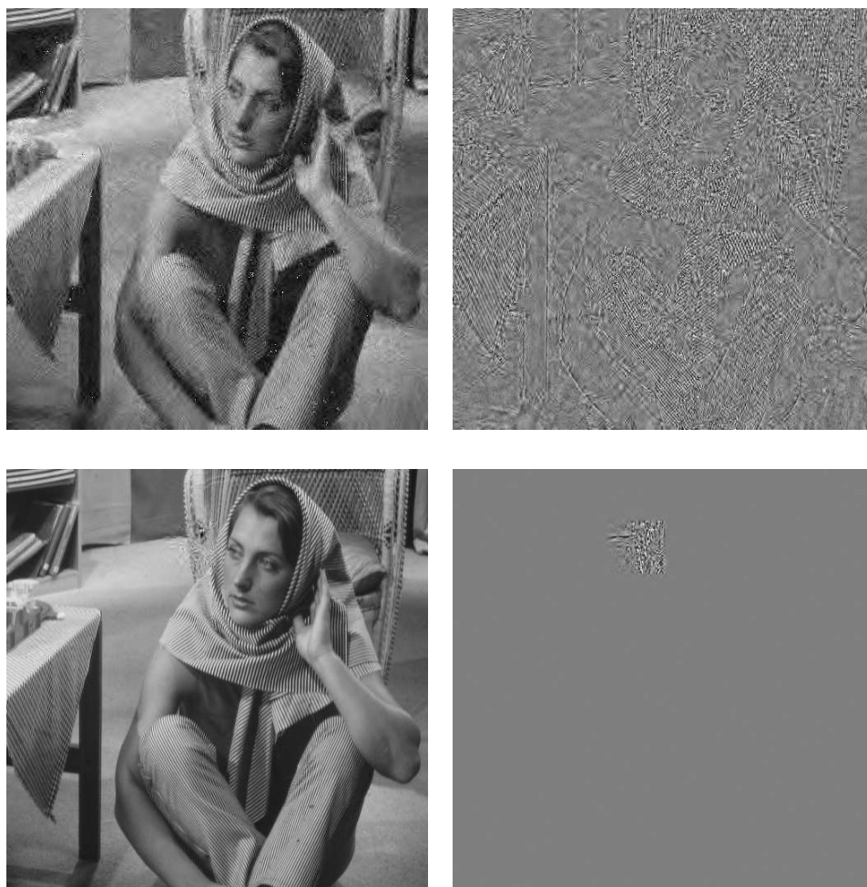
Fig. 4.4 Barbara et résistance aux erreurs : sans dispositif particulier (en haut) et avec la stratégie de résistance aux erreurs décrite dans la suite (en bas). L'image décodée est représentée à gauche et la différence par rapport à l'image d'origine à droite. L'erreur ne touche qu'un seul octet du train binaire.
